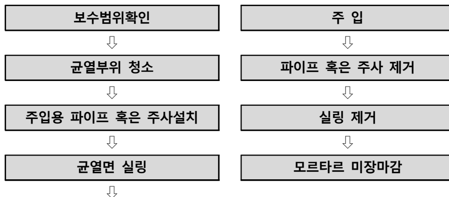
[그림 5.2.5] 주입공법의 시공순서
